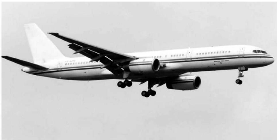
муществ над отечественными аналогами, то есть среднемагистральными самолетами Ту-134 и Ту-154. Для сравнения: дальность полета Boeing 757-200 с полной полезной загрузкой составляет 5470 км, Ту-154М – 3500 км. Boeing 757-200 вмещает до 228 пассажиров и расходует 3400 кг топлива в час. Ту-154М может перевозить до 180 пассажиров, а расход топлива составляет 5400 кг в час. Как говорится, почувствуйте разницу.
