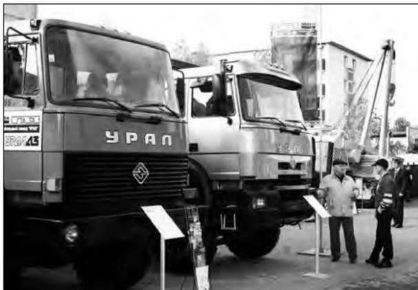
Непривычно смотрится бескапотная компоновка «Урала» последней модели.
