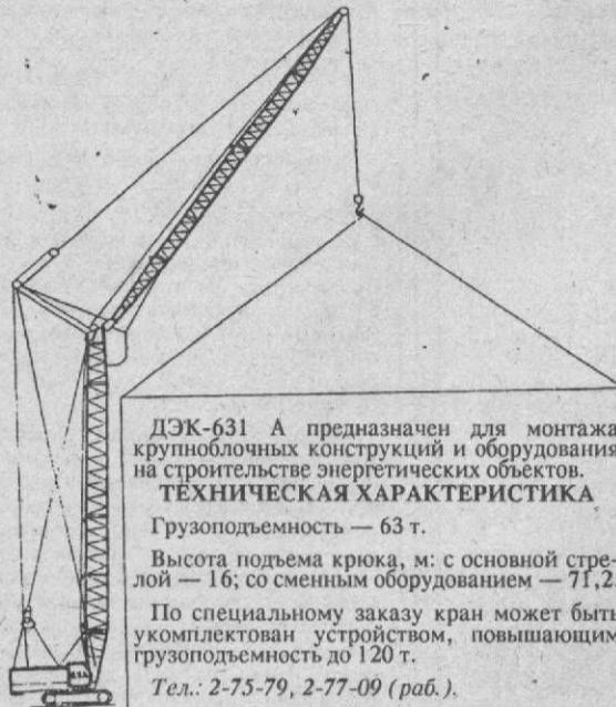
ДЭК-631 А предназначен для монтажа
