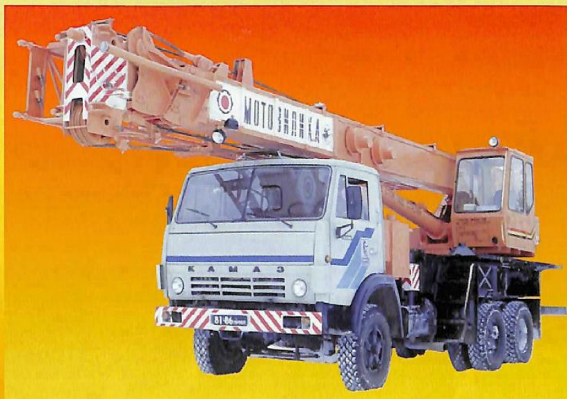
Автомобильный кран грузоподъемностью 25 тонн
